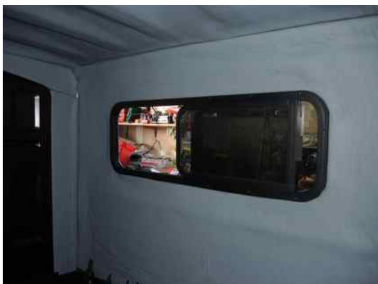
Verkleidung Fensterseite montiert
