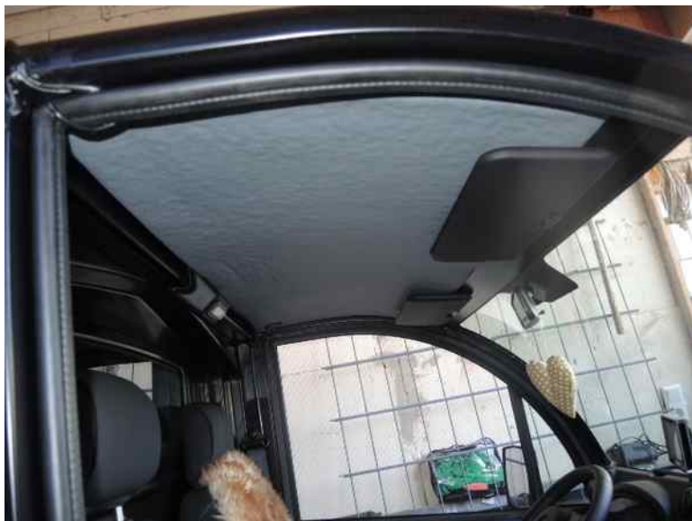
Neue Isolierung im Führerhaus
