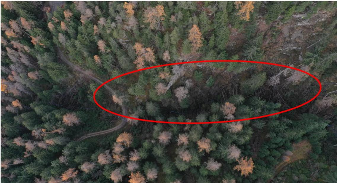
**Abbildung 13.3:** Verklauungsgefahr im untersten Bereich des Reischacherbaches (Aufnahme vom Jahr 2022) durch liegende Bäume, Astmaterial und Borkenkäferbefall
