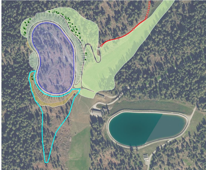
Abbildung 3: Einzugsgebiet des bergseitigen Drainagegraben
