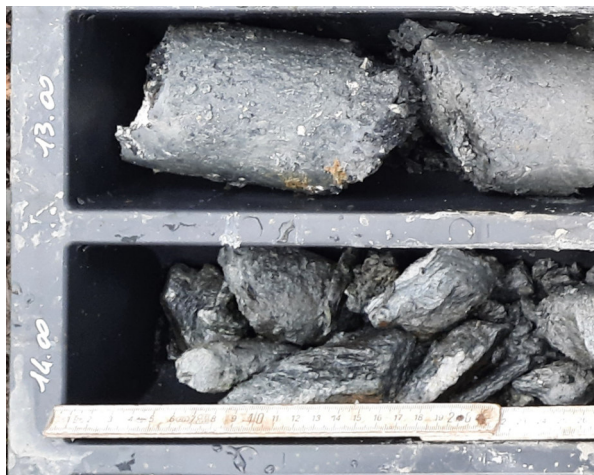
Foto 18: Bohrkern aus kataklastischen Graphitschiefern (Erkundungsbohrung S4).
